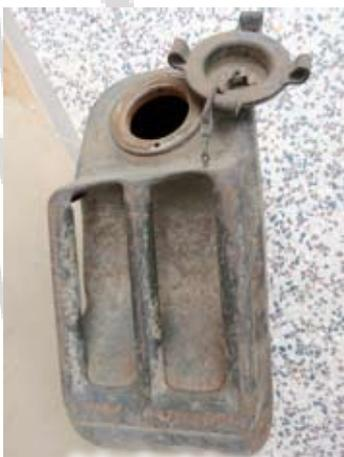
Le bouchon à vis source de tant de problèmes de remplissage.
